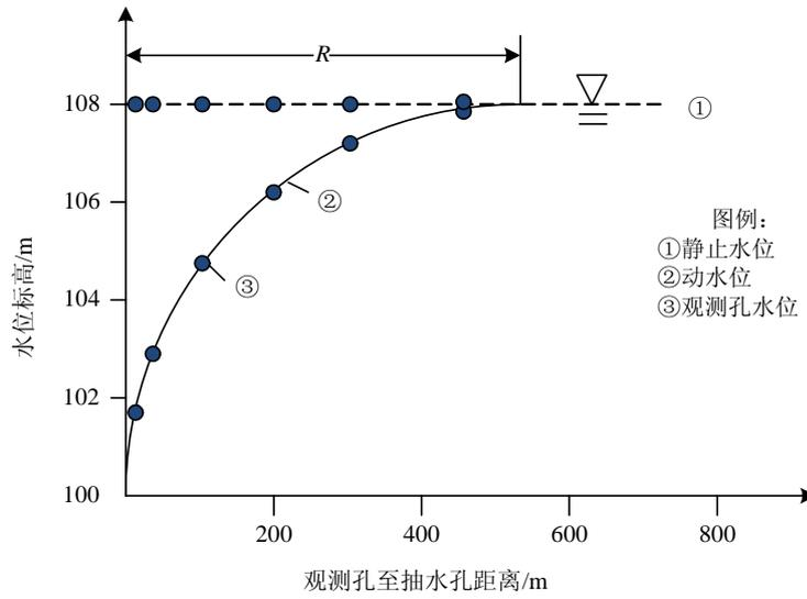
图 C.1 图解法确定影响半径示意图
